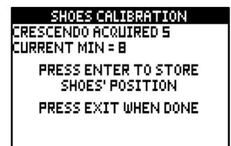
CURRENT MIN und CURRENT MAX werden nur angezeigt, wenn sich das Pedal in der minimalen bzw. maximalen Position befindet.
