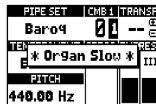
Nachdem ein Orchesterregister durch Aufrufen einer Kombination eingestellt wurde, ist es immer noch möglich die Stimme und die Parameter des aktuellen Pipe-Sets sofort wiederherzustellen, indem man die Register/Zugregister einige Sekunden lang lang (in der Position Stimme AUS) oder der Piston (wenn es EIN ist) gedrückt halten, während die Hauptvideoseite angezeigt wird.
