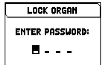
Um die Orgel zu entsperren, wählen Sie im Menü UTILITY das Feld UNLOCK ORGAN und geben Sie mit den oben beschriebenen Tasten das richtige Passwort ein. Wenn das Passwort korrekt ist, wird die Meldung "ORGAN ULOCKED" angezeigt.
