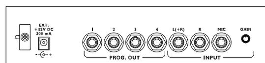
Auf der Rückseite der Orgel befinden sich verschiedene Buchsen für den Anschluss an externe Lautsprechersysteme, sowie Line- und Mikrofoneingang.
